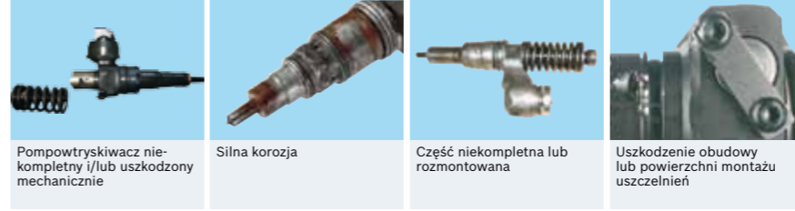
Silna, głęboka korozja korpusu pompy oraz uszkodzenia przyłączy elektrycznego
